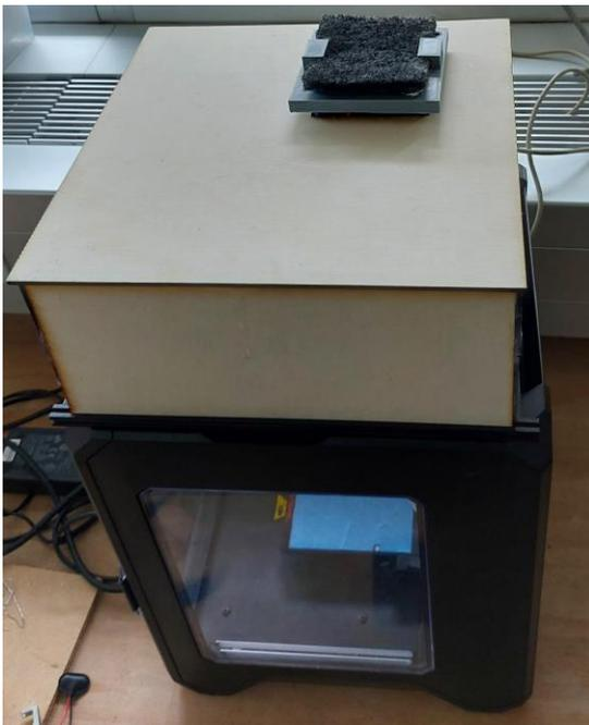
Abb.13 – Absaugung mit Aktivkohlefilter
